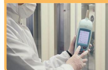
微粒子計測器は空気や液体の中に浮遊する微粒子を計測しています。高い清浄度管理が求められる、半導体などの精密機械や医薬品、食品の製造現場では、微粒子計測器による微粒子管理が行われており、ユーザーからの高い信頼を得ています。
